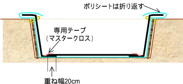
・パラシールの継目は平面部分とし、20cm幅重ねます。
